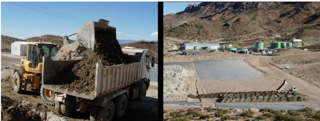
**Figura 3.** Transporte y volcado de las colas filtradas en el depósito.
